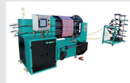
Mini Sample Warper RI M 601 (50 cm / 5-30 meter / 8 colours)
